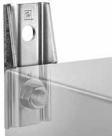
Los Kits para brackets de montaje pueden ser instalados in sitio. Los Brackets plásticos y de acero cumplen con Tipo 4X. Un juego de cuatro (4) puede soportar hasta 500 lb. La tornillería está incluida.
