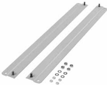
Usados para montar el gabinete a la pared o a otro gabinete. Incluye dos brackets de montaje de acero de 2.5 mm de grosor (Calibre 12), así como tornillería. Acabado Texturizado con pintura en polvo de poliéster de color Gris Claro RAL 7035.
